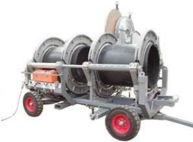
Aparatura za zavarivanje PE cijevi velikog prečnika
